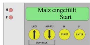
Wenn Sie das Malz eingefüllt haben quittieren Sie das mit ENTER. Zur Sicherheit erfolgt nochmals die Abfrage „Malz eingefüllt?“. Mit START starten Sie nun den eigentlichen Brauprozess mit dem Braumeister. Die Pumpe und Heizung schaltet ein. Die Würze steigt im Rohr auf und läuft über. Der Kreislauf ist entstanden und das Malz wird durch das Umpumpen über die nächsten Phasen ausgewaschen.
