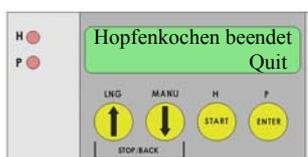
Mit Ablauf der Kochzeit ertönt wieder ein Signalton, der das Ende des Brauvorgangs anzeigt. Dies wird mit ENTER quittiert. Die Heizung wird abgeschaltet.
