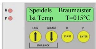
Stecken Sie den Braumeister ein. Die Steuerung befindet sich dann im Grundzustand. Zum Programmieren eines Rezeptes und dessen Zeit- und Temperaturwerte drücken Sie 1 sec die Taste ENTER.
