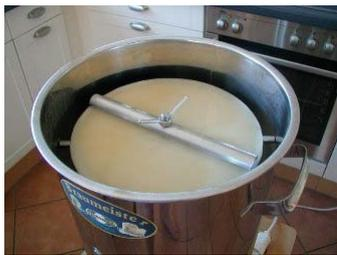
Die Automatik nun mit START fortsetzen. Hell gefärbtes Brauwasser steigt auf und läuft über. Der Kreislauf hat begonnen. Die nächsten Brauphasen werden vollautomatisch gemäß Programm durchlaufen. Während einiger Brauphasen erfolgt per Steuerung eine kurze Pumpenpause, um das Malz neu zu positionieren. Das Display zeigt die Ist- und Solltemperaturen sowie die Restzeit, welche nach Erreichen der Sollzeit rückwärts läuft (blinkend).
