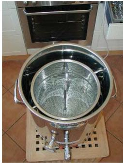
Mit Erreichen der Einmischtemperatur ertönt ein Signalton, welchen Sie mit ENTER quittieren. Nun das Malzrohr einsetzen (mit aufgezogener Dichtung nach unten). Darauf achten, dass Dichtung mit Malzrohr zentriert und absolut eben auf dem Kesselboden aufsitzt. Siebblech bis auf unteren Rand einschieben (Rohr nach oben). Darauf Filtertuch einlegen (im Wasser unten auflegen).
