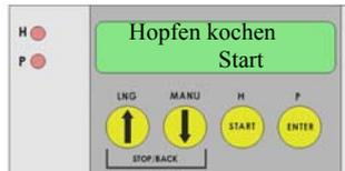
Nach Entfernen des Malzrohres quittieren Sie dies wieder mit ENTER. Zum starten des Hopfenkochens drücken Sie START. Pumpe und Heizung wird eingeschaltet und die Automatik wird fortgesetzt.
