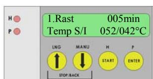
Die Anzeige zeigt nun die Rast, Soll- und Ist-Temperatur und die Zeit. Nach Erreichen der Soll-Temperatur wechselt die Zeitangabe in eine rückwärtslaufende Restzeitangabe (blinkend) für diese Phase. Die weiteren Phasen werden vollautomatisch abgearbeitet. Das Display zeigt dabei auch wie in Phase 1 die entsprechenden Zeiten und Temperaturen.
