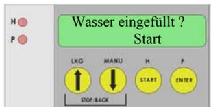
Nach Bestätigen aller Programmstufen mit ENTER gelangen Sie wieder in den Grundzustand. Von dort aus können Sie die Brau-Automatik mit Drücken der Taste START (1 sec) starten. Folgen Sie nun den Anweisungen des Programms!
