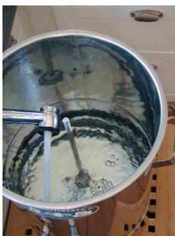
53l Brauwasser einfüllen – bis ca. 2cm unter der oberen Markierung an der Zugstange bzw. am Füllstandsmesser. Folgen Sie den Anweisungen der Brausteuerung, indem Sie mit ENTER quittieren, daß Wasser eingefüllt ist. Die Pumpe entlüftet selbstständig und die programmierte Einmischtemperatur wird angefahren.
