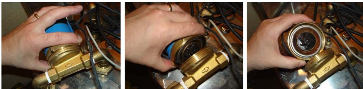
Lösen von Hand, Pumpe öffnen, darin befindet sich das Pumpenrad
