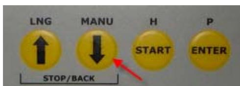
Stellen Sie die Temperatur manuell auf 60° ein und starten Sie bitte die Pumpen mehrmals manuell, so dass sich erwärmt und die Pumpen entlüftet und gespült werden mit warmem Wasser.
